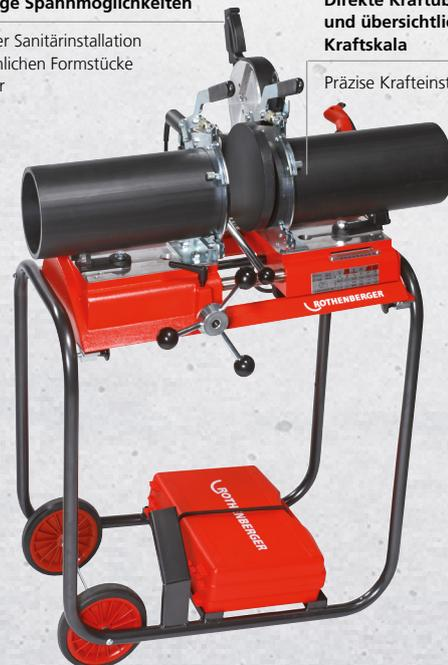
Set beinhaltet: Grundmaschine mit elektrischer Fräseinrichtung, elektronisch regelbarem Heizelement, herausnehmbar. Grundspannbackensatz rechts und links Ø 160 mm (No. 54082), Rohrauflagen Ø 160 mm, Reduktionsspann- und Auflagensätze für Ø 40, 50, 56, 63, 75, 90, 110 und 125 mm im Koffer (No. 1000002970), Montagewerkzeug, fahrbares Arbeits- und Transportgestell (No. 1000002971) Fräsermesser (No. 55685 / 55684 HM)
